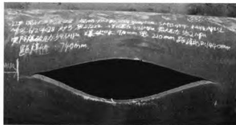
图2  $\Phi 558.8\text{ mm}\times 25.4\text{ mm}$  焊管爆破口全貌
