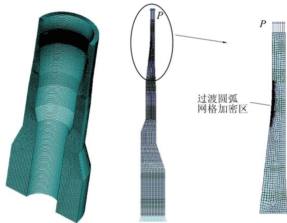
(a) 1/2 网格模型 (b) 轴对称网格模型 (c) 局部放大网格模型
