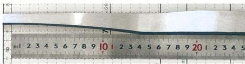
图 5 Φ73 mm 钛合金钻杆管端锻造成型效果示意
