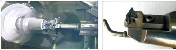
图 8 粗车工序刀杆前端可拆卸小钩
