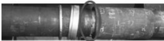
图 7 螺纹过盈量为 0 mm 时接头拉伸失效形貌
