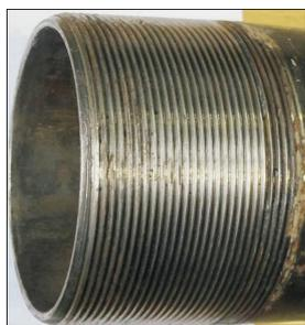
图2 与脱扣接箍工厂端连接的外螺纹形貌
