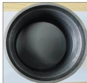
图3 脱扣接箍工厂端面形貌
