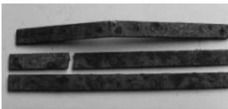
图 4 G105 钢级钻杆在 NACE 标准环境下(状态 1) SSC 试样的宏观照片
