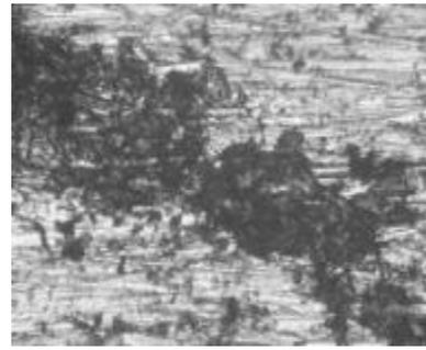
图9 G105 钢级钻杆在 NACE 标准环境下(状态 1) SSC 试样去除腐蚀产物后的金相照片
