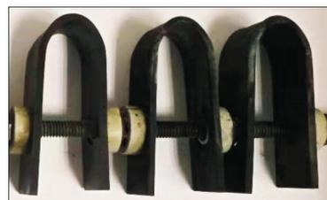
图 9 不同材质在 125 °C 20% NaOH 溶液中 168 h 后的腐蚀形貌
