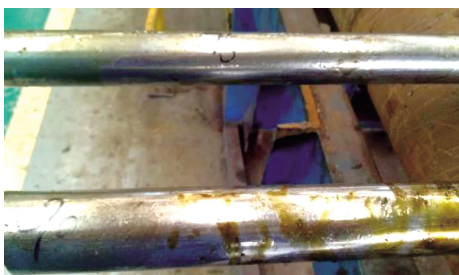
图 4 冷轧后不锈钢钢管表面残余轧制油形态
