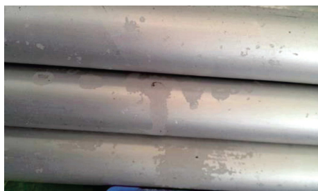
图 3 氧化性气氛导致的钢管表面“花斑”
