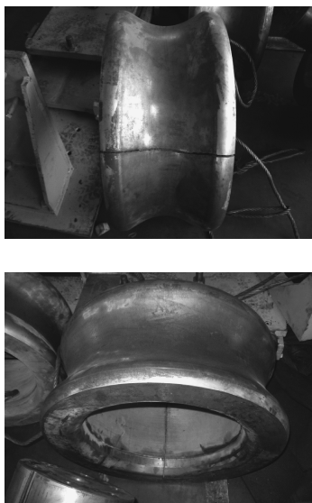
图 1 PQF 连轧辊辊环的失效形式
