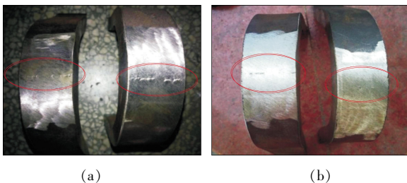
图1 焊缝导向弯曲不合格试样示意
