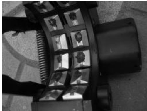
图 5 防腐层材料黏附于探头
