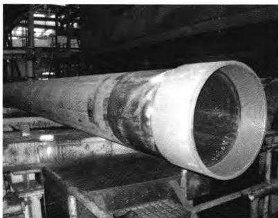
图1 HFW  $\Phi 473.08 \text{ mm} \times 11.05 \text{ mm}$  K55 钢级套管
